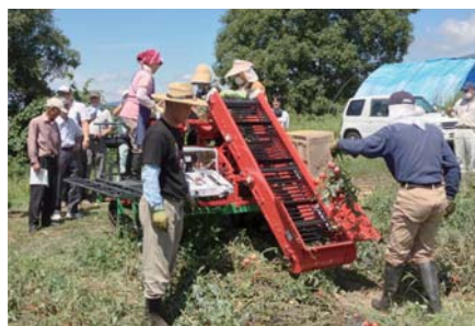
高効率の加工用トマトの収穫機械
