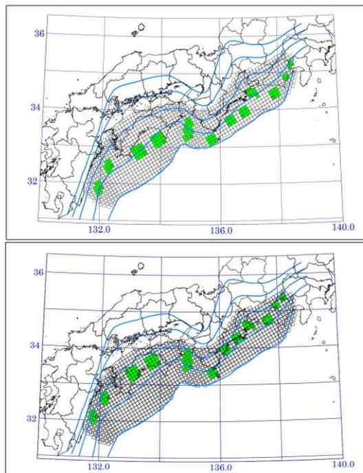
(図1-3) 南海トラフの巨大地震の断層モデル
