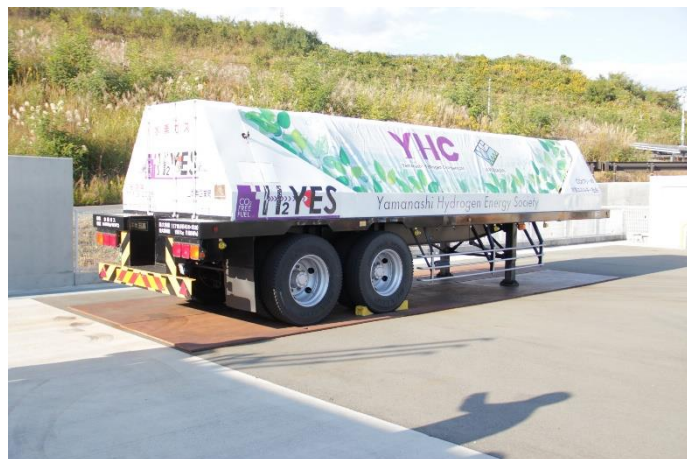
圧縮された水素はパッケージ化(赤タンク:50 m 3 )され、トレーラー(2,700 m 3 )へ。
