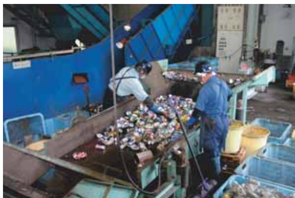
不燃コンテナに投入されたペットボトルやびんなどを拾い出す作業
