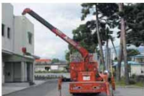
②クレーン 最大2.93トンまで吊上げが可能です。 例) 地震等により車輛の上部に電柱等の重量物が倒れ脱出できない場合、排除する際に使用します。
