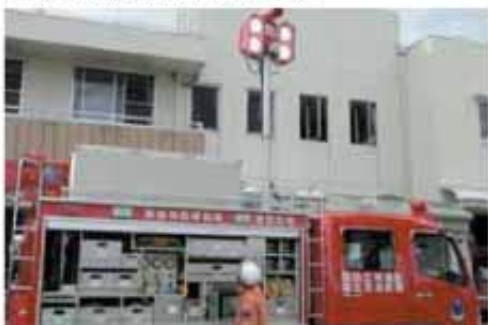
③発光照明装置 車体の上面に、地上高6mまで上昇する600Wのメタルハライドランプが4灯装備されています。夜間の活動では、火災や交通事故はもちろんのこと、活動範囲が広がるため捜索活動でも威力を発揮します。また、隊員の安全性も向上します。
