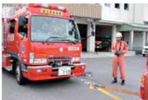
①ウインチ 車体前後に装備され、最大引張能力は5トンです。 例) 交通事故でハンドルに挟まれ車外に脱出できない人を救助する際、車輛を固定し、牽引する場合に使用します。
